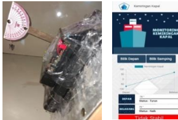
Gambar 3.5 Kondisi Tidak Stabil
