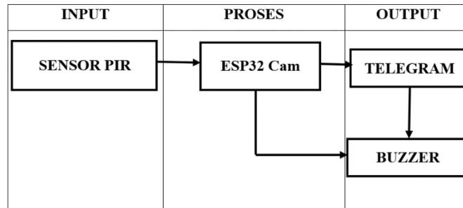
Gambar 2. Diagram Blok
