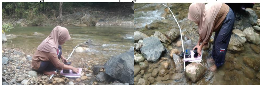
Gambar 2. Dokumentasi pemasangan sensor aliran air YF-S201 pada saluran pengarah
