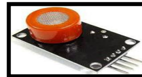
Gambar 2. Sensor MQ 7 untuk mendeteksi gas CO.
