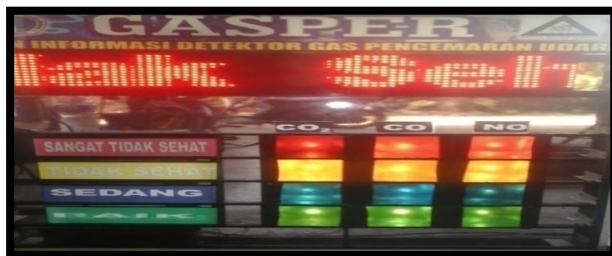
Gambar 16. Tampilan Alat, Kadar Gas CO 2 , CO, dan NO dalam kondisi sangat tidak sehat
