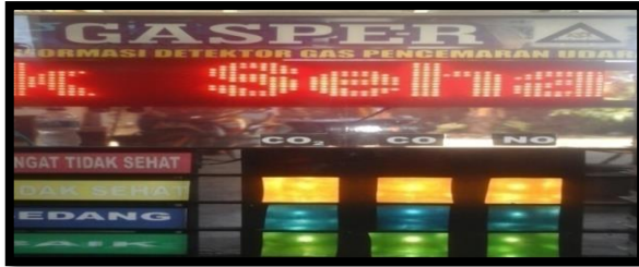
Gambar 15. Tampilan Alat, Kadar Gas CO 2 , CO, dan NO dalam kondisi tidak sehat
