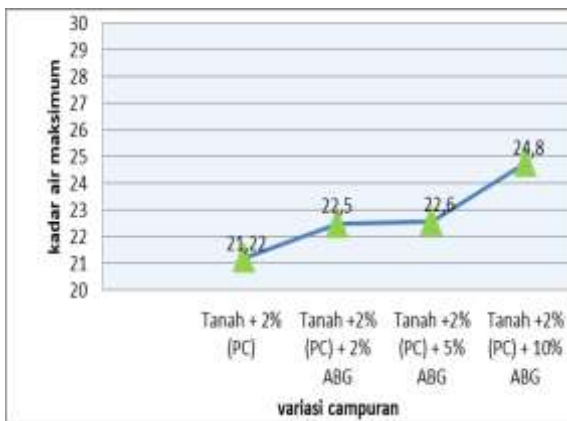
Gambar 4. Grafik hubungan antara kadar air optimum tanah ( w_{opt} ) dan variasi campuran
