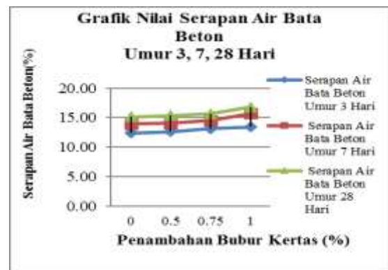
Gambar 2. Grafik pengujian serapan air bata beton umur 3, 7, dan 28 hari
