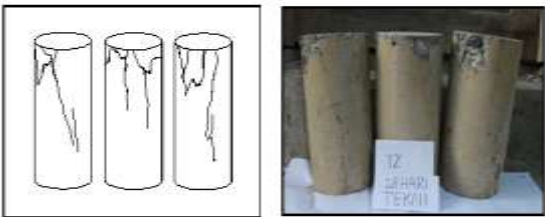
Gambar 7. Gambar Pola Retak Benda Uji Dengan Penambahan Roving
