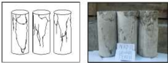
Gambar 7. Gambar Pola Retak Benda Uji Beton Normal
