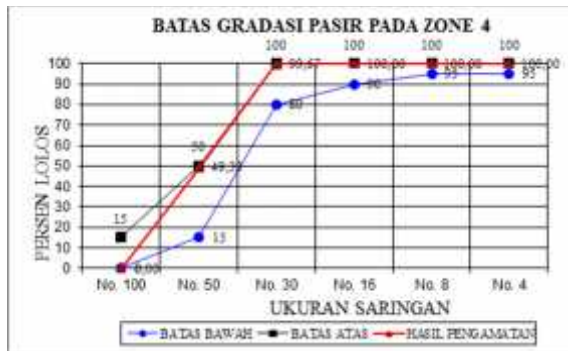
Gambar 3. Batas gradasi pasir besi
