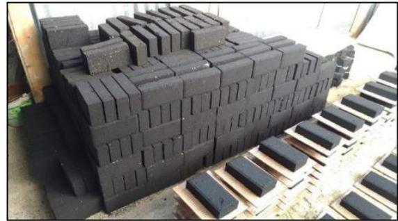
**Gambar 9.** Pembuatan *Paving Block* Aspal.
