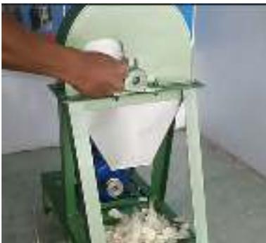
Gambar 4. Mesin pengiris singkong dengan penggerak motor listrik
