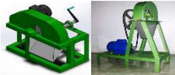
Gambar 3. Pengiris singkong manual dan mesin pengiris dengan penggerak motor
