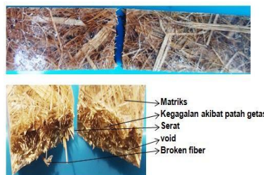
Gambar 9. Contoh Patahan Spesimen Uji Tarik perendaman air tawar Setelah Dilakukan Pengujian
