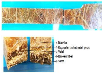
Gambar 10. Contoh Patahan Spesimen Uji Tarik perendaman air tawar Setelah Dilakukan Pengujian
