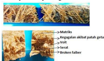
Gambar 8. Contoh Patahan Spesimen Uji Impak perendaman air tawar Setelah Dilakukan Pengujian
