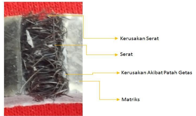
Gambar 12. Spesimen uji bending setelah pengujian
