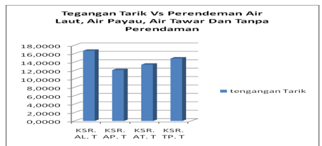
Gambar 9. Gambar diagram tegangan tarik komposit serat rambut
