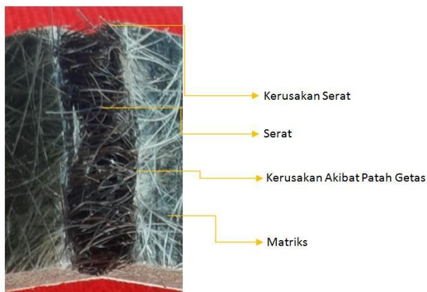
Gambar 11. Spesimen uji tarik setelah pengujian
