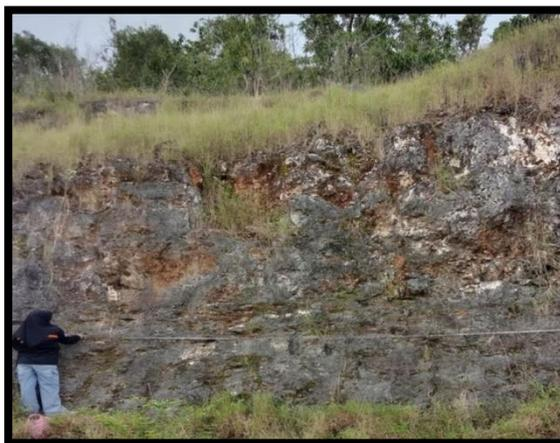
Gambar 1 Pengukuran Bentangan Scanline
